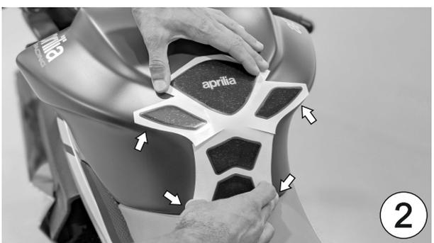
**D** Den Schutzkit in der zuvor am Tank eingepägten Position halten und die untere Schutzfolie wie auf Abbildung 4 gezeigt abziehen und abschneiden.
