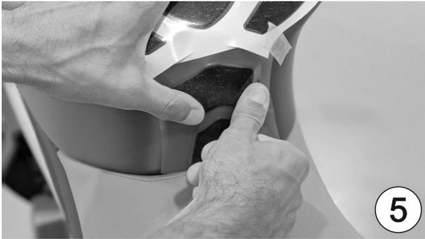
**D** Nachdem der untere Teil der Schutzfolie entfernt wurde, die entsprechenden Teile des Schutzkits sorgfältig anpressen. Zuerst den mittleren Bereich und anschließend die Randbereiche anpressen, wie auf der Abbildung 5 gezeigt wird.
