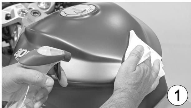
**D** Den Bereich des Tanks, an dem der Schutz angebracht werden soll, sorgfältig reinigen.
