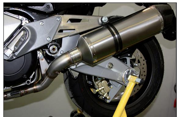
Montare il silenziatore Malossi nel raccordo centrale, montare la molla tra silenziatore e raccordo e fissare il silenziatore alla staffa di supporto con la fascetta in carbonio
