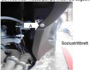
**Schritt 9:**Verwenden Sie bei den Markierungen A und B die Blechschrauben 4,2x19mm. Demontieren sie die Windschutzscheibe wie folgt.
