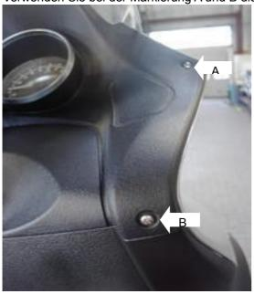
**Schritt 4:**Dieser Vorgang zeigt die linke Fahrzeugseite, da diese Klappe nur links vorhanden ist. Nutzen Sie für die Markierung A eine Blechschraube 4,2x19mm.
