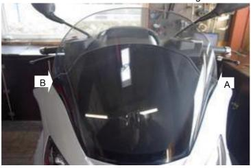
**Schritt 9.1:**Entfernen Sie das Piaggio Logo mit Hilfe eines kleinen Schlitzschraubendreher. Hebeln Sie das Logo von der rechten Seite nach oben hinaus.
