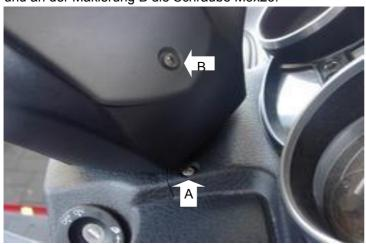
Schritt 7: Nutzen Sie an der Markierung A die Blechschraube 4,2x13mm. Bei Markierung B die Schraube M6x40.
