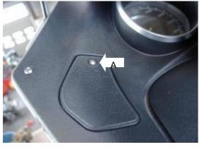
**Schritt 5:** Verwenden Sie an der Markierung A die Schraube M6x20.
