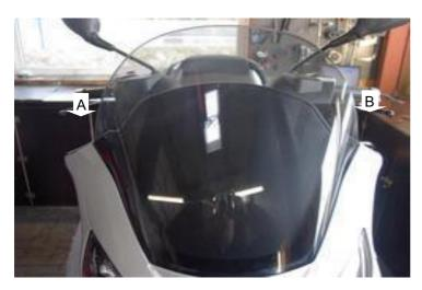
Schritt 9.4: Nach lösen der Schrauben 1 bis 6 können Sie die Scheibe abnehmen.
