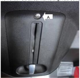
**Schritt 6:** An der Makierung A verwenden Sie die Blechschraube 4,2x16mm und an der Makierung B die Schraube M5x25.
