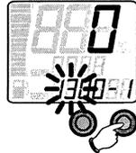
Appuyer sur le bouton "set" régler le capteur.
