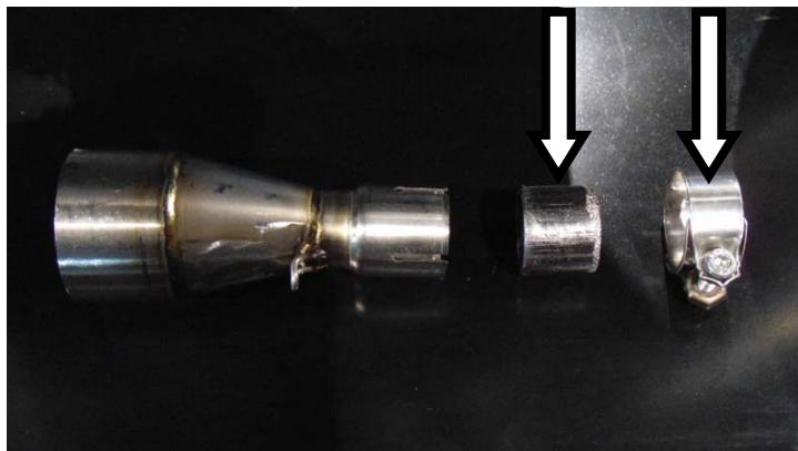
**IT** · Posizionare guarnizione e fascetta nell'innesto del raccordo
