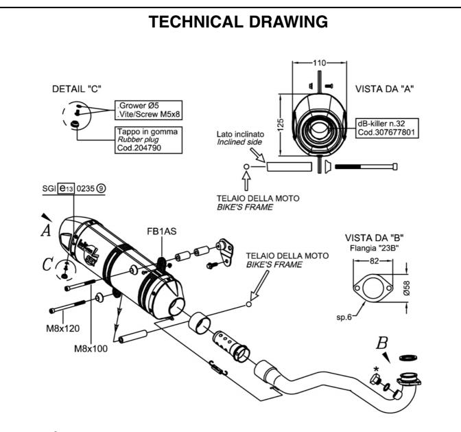
I) Componenti forniti in confezione e da utilizzare solo sulle motociclette non dotate di sonda Lambda:
