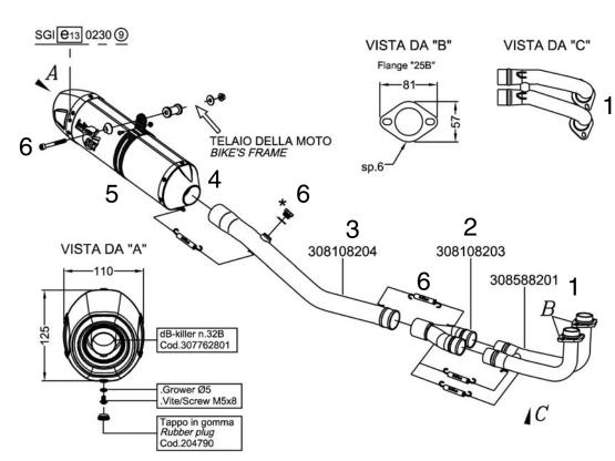
6 \* I) Componenti forniti in confezione e da utilizzare solo sulle motociclette non dotate di sonda Lambda: .Tappo M18x1,5 h.9
