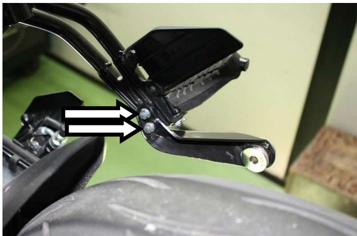
IT · Svitare le viti indicate (2) e sostituire la staffa di sostegno originale con quella fornita (lunga per versione 125, corta per 390 – vedere foto per dettagli)
