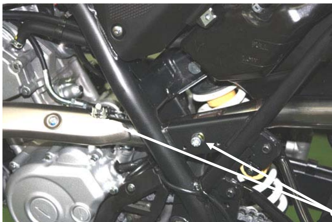
Innestare il terminale ARROW, fissarlo con gli appositi attacchi e stringere la fascetta stringitubo Fit Arrow silencer to OE header secure it to the frame and tighten the hose clip
