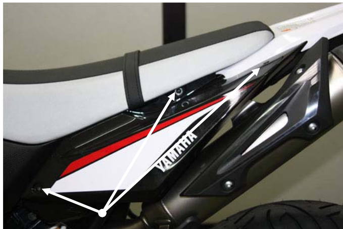
Svitare le 3 viti della fiancatina laterale, poi rimuoverla Unscrewing the screws fixing the number plate and remove it
