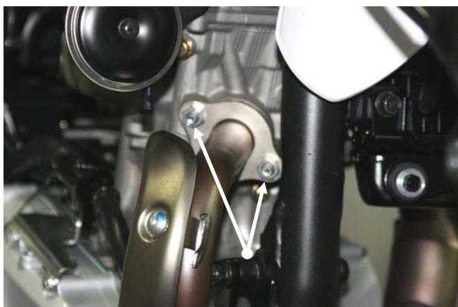
Smontare anche il collettore attraverso i 2 bulloni della flangia al cilindro e staccare il tubo del ricircolo dell'aria
