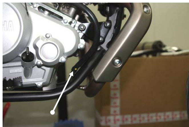
Smontare anche il collettore attraverso i 2 bulloni della flangia al cilindro e staccare il tubo del ricircolo dell'aria
