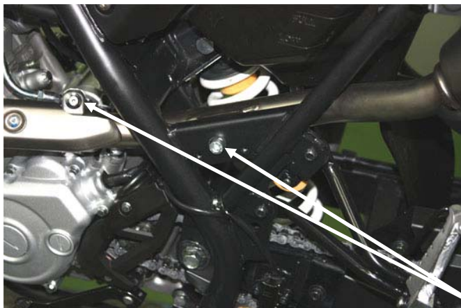
Svitare le 2 viti indicate e allentare la fascetta stringitubo, poi rimuovere il terminale originale Unscrew the screws shown in pictures above then remove OE silencer
