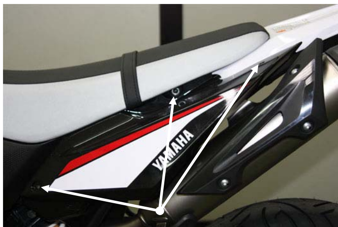
Svitare le 3 viti della fiancatina laterale, poi rimuoverla Unscrewing the screws fixing the side fairing and remove it
