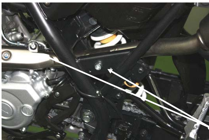
Svitare le 2 viti indicate e allentare la fascetta stringitubo, poi rimuovere il terminale originale Unscrew the screws shown in picture, loosen the hose clip and remove the silencer
