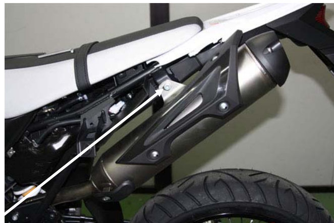
Svitare le 2 viti indicate e allentare la fascetta stringitubo, poi rimuovere il terminale originale Unscrew the screws shown in pictures above then remove OE silencer
