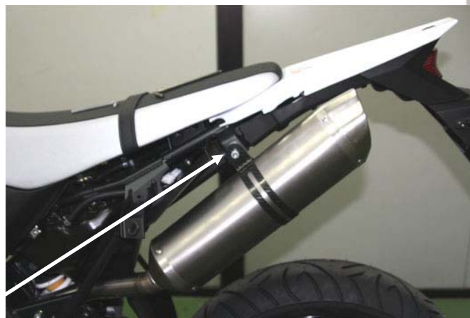
Dopo aver trovato la corretta posizione del silenziatore fissare il tutto Once the silencer is in the correct position, fix it to the frame as shown in picture
