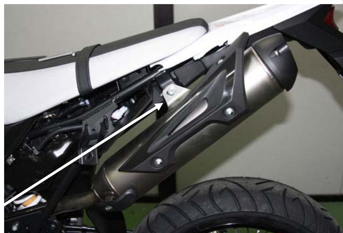
Svitare le 2 viti indicate e allentare la fascetta stringitubo, poi rimuovere il terminale originale Unscrew the screws shown in picture, loosen the hose clip and remove the silencer
